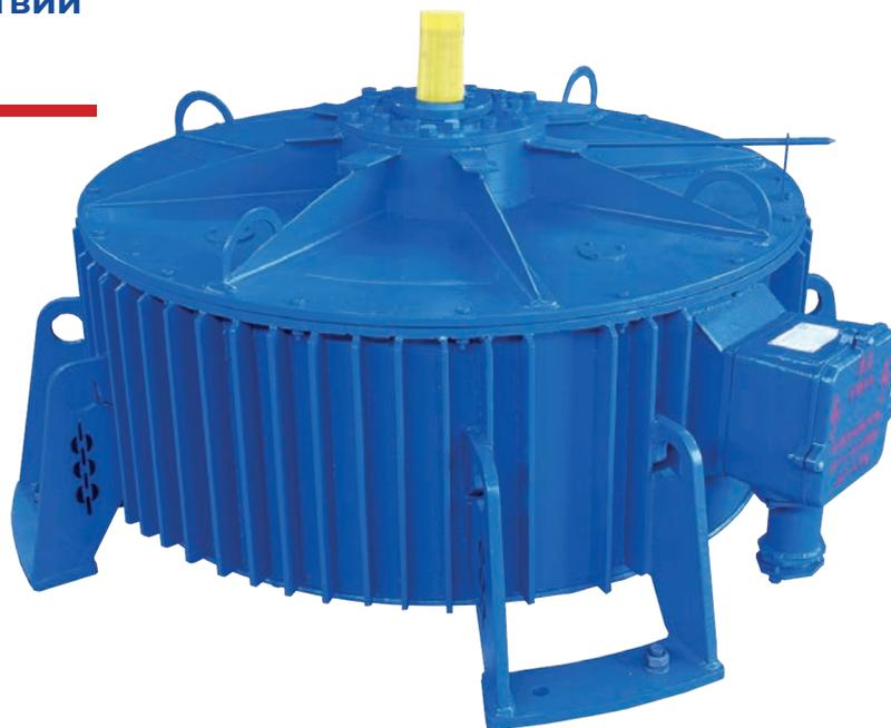
Двигатель выполняется вертикальным закрытым с одним выступающим свободным концом вала, направленным вверх, для непосредственной насадки вентилятора градирни. Двигатель – реверсивный, направление вращения меняется переключением фаз статора при неподвижном роторе. Выдерживает кратковременную перегрузку по току на 50% в течение одной минуты.
