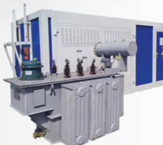
**Блок-контейнер с пунктами автоматического регулирования напряжения типа БК ПАРН** предназначен для регулирования (поддержания требуемого уровня) напряжения в электрических сетях напряжением 6/10 кВ трехфазного переменного тока частотой 50 Гц.
