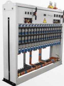
Шкафы распределительного низкого напряжения ШРНН внутренней установки предназначены для комплектования распределительных устройств напряжением 0,4 кВ переменного тока частотой 50 Гц с глухозаземленной нейтралью, служащих для приема, распределения электрической энергии, защиты от перегрузок и токов короткого замыкания отходящих линий.
