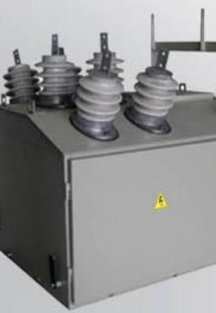
**Пункт коммерческого учёта столбовой (ПКУ-С)** производит учёт активной и реактивной энергии прямого и обратного направления в цепях переменного тока напряжением 6/10 кВ, номинальным током до 630 А и частотой 50 Гц. Может быть использован в составе автоматизированных систем контроля и учёта электроэнергии (АСКУЭ), в качестве передатчика данных на диспетчерский пункт контроля, распределения и учёта электроэнергии.
