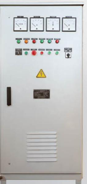
**Тиристорный возбудитель серии ВТЕ-320** предназначен для питания обмотки возбуждения и управления током возбуждения синхронных двигателей при прямом или реакторном пуске от сети. Возбудитель обеспечивает прямой пуск двигателя, плавную регулировку и стабилизацию тока возбуждения, ограничение напряжения и тока возбуждения, защиту ротора от длительной перегрузки по току.
