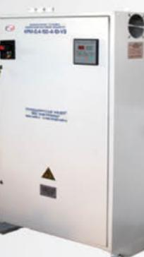
**Компенсаторы реактивной мощности (KPM)** предназначены для автоматического и ручного регулирования коэффициента мощности в распределительных сетях трехфазного переменного тока частотой 50 Гц, мощностью от 20 до 1000 кВАр. Функциональные особенности: выбор режима регулирования; индикация параметров; автомат защиты; естественное охлаждение до 175 кВАр и принудительное воздушное свыше 200 кВАр; напольное исполнение.
