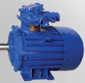
Электродвигатели асинхронные трехфазные взрывозащищенные с короткозамкнутым ротором ВАО7 предназначены для работы от сети переменного тока частотой 50 Гц в качестве привода различных механизмов, применяемых в местах эксплуатации, в которых по технологии производства возможно образование взрывоопасной концентрации газов, паров и пыли.
