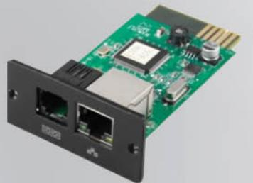
**Средства коммуникации** предназначены для обмена данными и информацией между ИБП и компьютером посредством интерфейсов RS-232, USB, SNMP и сухих контактов, обеспечивая локальный и дистанционный мониторинг ИБП.
