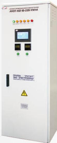
**Аппарат управления оперативным током (AYOT) с номинальным током от 5 А до 480 А** предназначен для бесперебойного питания потребителей постоянного тока стабилизированным напряжением от 24 В до 220 В и обеспечения заданных режимов заряда-подзаряда аккумуляторных батарей, с контролем их состояния.
