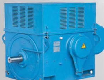
**Электродвигатели переменного тока с фазным ротором АК4** предназначены для привода механизмов с тяжелыми условиями пуска и требующих регулирования частоты вращения, момент которых не зависит от частоты вращения, а так же механизмов, момент которых изменяется по вентиляторной характеристике.
