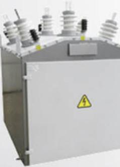
**Комплектное устройство К-112 П** реклоузер предназначено для секционирования воздушных линий с односторонним или двухсторонним питанием, автоматического включения резервного питания, плавки гололеда, сетевого резервирования на воздушных линиях передачи электрической энергии при номинальном напряжении 6/10 кВ.
