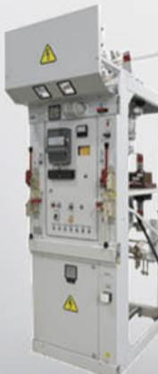
**Камеры КСО 298 (206) и 393 (366)** одностороннего обслуживания предназначены для работы в составе распределительных устройств переменного трехфазного тока частотой 50 Гц, номинальным напряжением 6/10 кВ, с изолированной нейтралью, заземленной через дугогасительный реактор.
