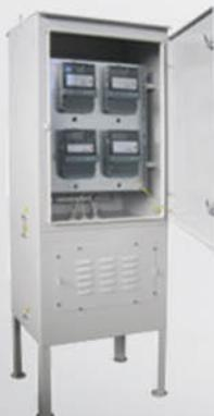
Шкаф коттеджный наружной установки ШКН предназначен для приема, распределения, учета электроэнергии в жилых и общественных зданиях напряжением 380/220 В переменного тока частотой 50 Гц в сетях с глухозаземленной нейтралью и для защит групповых линий от токов короткого замыкания и перегрузки. Шкаф является устройством двустороннего обслуживания.
