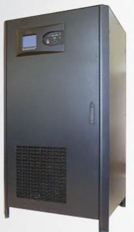
**Трехфазный промышленный источник бесперебойного питания двойного преобразования энергии Исток серии ИДП-3 мощностью от 10 до 200 кВА** обеспечивает стабильную подачу напряжения с максимальной мощностью и эффективностью. Высокий входной коэффициент мощности (0,99), КПД на уровне 96%, низкий коэффициент искажения синусоидальности входного тока, что в сочетании с интеллектуальной системой заряда батарей способствует повышению надежности системы и снижению эксплуатационных расходов.
