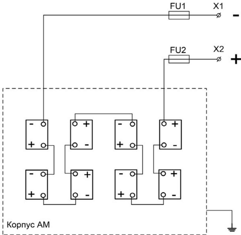
FU1, FU2 - Держатель предохранителя RT-18
