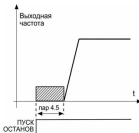
Рисунок 9.4: Время торможения постоянным током при пуске
