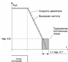
Рисунок 9.6: Время торможения постоянным током в режиме останова с линейным замедлением
