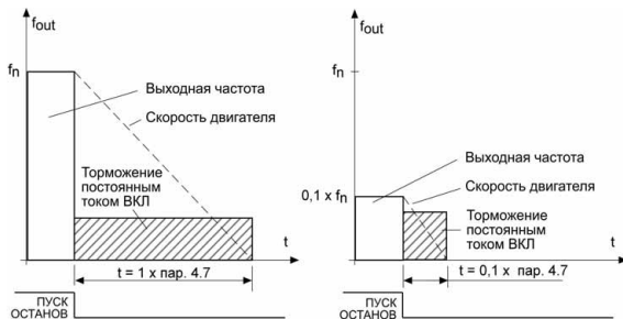
Рисунок 9.5: Время торможения постоянным током в режиме останова с выбегом
