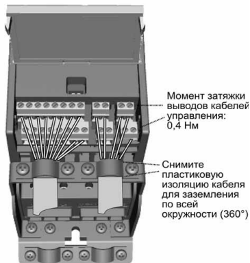
Рисунок 3.8: Смонтируйте кабели управления. См. главу 6.2
